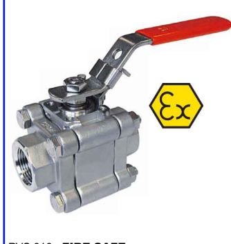
RVS 316 - FIRE SAFE 3-delig volle doorlaat - PN140/100 - 220°C fig 177T HT : PN140/100 1/4"-2" bsp fig 178T HT : PN140/100 1/4"-2" BW fig 177T HT NPT : PN140/100 1/4"-2" npt fig 178T HT SW : PN140/100 1/4"-2" SW
