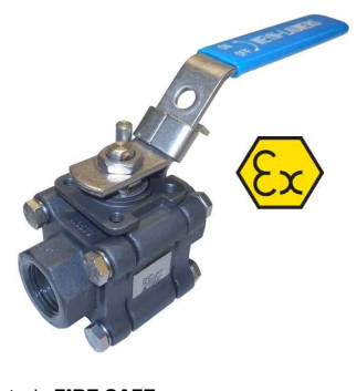
staal - FIRE SAFE 3-delig - volle doorlaat - PN140/100 - 220°C fig 167T HT : PN140/100 1/4"-2" bsp fig 168T HT : PN140/100 1/4"-2" BW fig 167T HT NPT : PN140/100 1/4"-2" npt fig 178T HT SW : PN140/100 1/4"-2" SW
